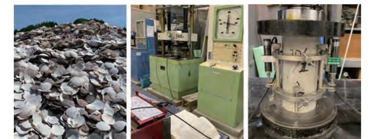
図1 ほたて貝殻と圧縮強度試験の様子
