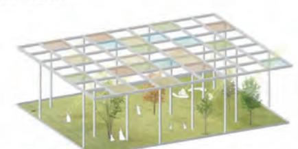
屋根は元の骨組みを残して、リサイクルセンターでは作成可能な繊維入りプラスチック (FRP) を使って、光の調節が行われます。陽樹が植えている場所では透明FRPを使って、光を透過させます。
