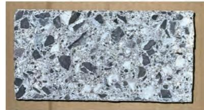
図1 高炉スラグを使用した供試体
